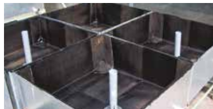
2. Vasche di prova impermeabilizzate
